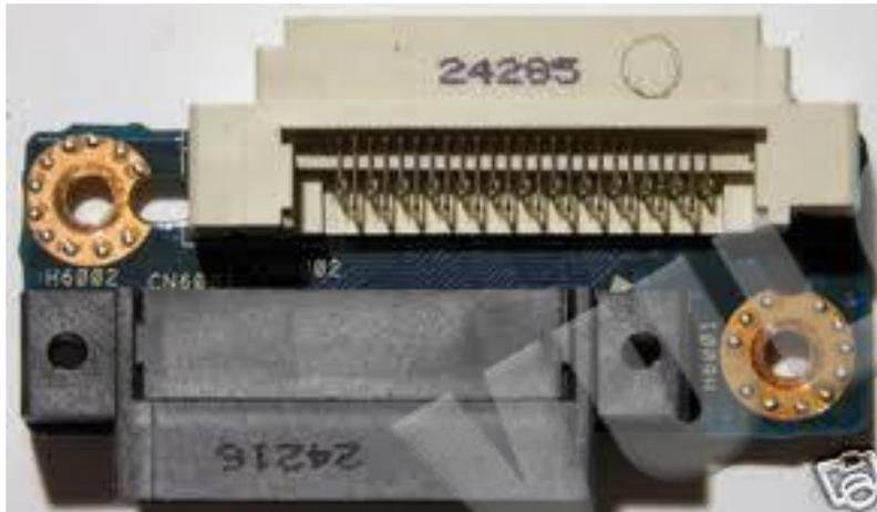
Ejemplo de placa de interconexión entre un dispositivo óptico y el CPU
