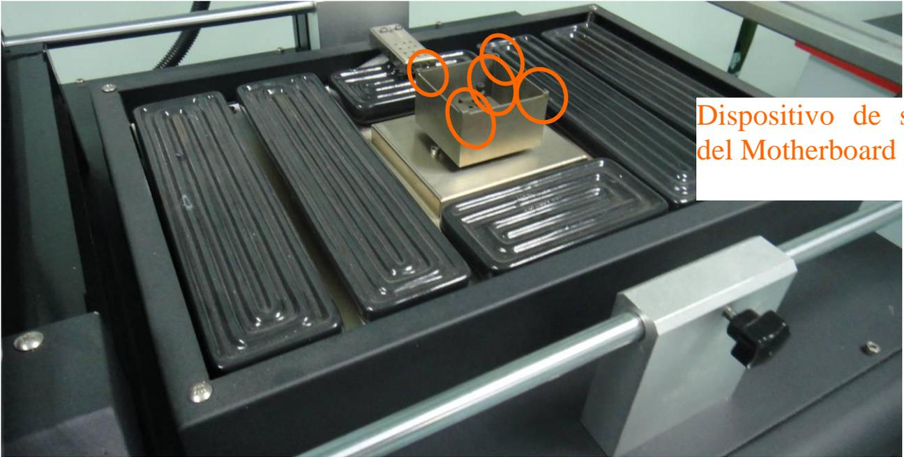
Dispositivo de sujeción del Motherboard
